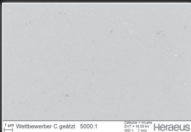
Typowy materiał ceramiczny do powlekania dwutlenku cyrkonu, bez dodatku leucytu.
